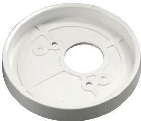
Задняя панель обеспечивает высокую степень защиты от попадания воды или пыли в заднюю часть извещателя, установленного непосредственно на монтажной коробке. Когда задняя панель используется с устройством XP95, номерной язычок карты XPERT должен быть отщеплен и вставлен в одно из отверстий для заглушек, имеющихся на задней панели.
