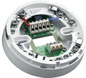
База вспомогательных реле серии 65 имеет два набора бесполюсных переключающих контактов для облегчения переключения удаленного светоизлучателя или другого вспомогательного устройства.
