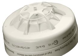
Orbis I.S. Термовой извещатель контролирует температуру с помощью одного термистора, который обеспечивает выходное напряжение, пропорциональное температуре наружного воздуха.
