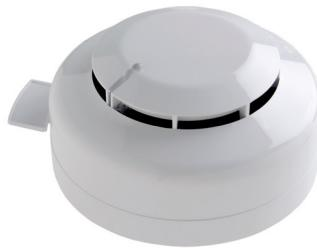
Оптический дымовой извещатель Soteria использует технологию оптического зондирования PureLight для обнаружения частиц дыма, попадающих в камеру. PureLight знаменует новый этап в развитии оптической технологии Apollo и направлен на снижение вероятности ложных срабатываний и повышение надежности обнаружения реального пожара.
