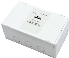
Модуль мониторинга переключения предназначен для отслеживания состояния одного или нескольких однополюсных бесконтактных контактов, подключенных к одной паре кабелей, и для передачи отчета об их состоянии на совместимое с Apollo аналоговое управляющее оборудование.
