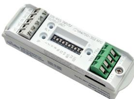
Модуль ввода / вывода на DIN-рейку обеспечивает наблюдение за одним или несколькими нормально разомкнутыми бесконтактными контактами, подключенными к одной паре кабелей, и набором выходных контактов переключающего реле.
