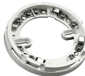
Стандартное основание Series 65 позволяет устанавливать извещатели без применения силы, что особенно полезно при установке на подвесные потолки. Все базы Series 65 подходят только в одном направлении. Детекторы можно зафиксировать установочным винтом с помощью шестигранной отвертки 1,5 мм.
