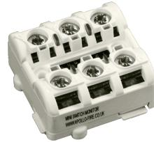
Миниатюрное устройство мониторинга переключения - это модуль в совершенно новом корпусе. Это позволяет установить устройство на стандартную 35-миллиметровую DIN-рейку (с помощью поворотного щелчка) или установить внутри корпуса, например, ручного извещателя. Он предназначен для отслеживания состояния одного или нескольких однополюсных бесконтактных kontaktов, подключенных к одной паре кабелей, и для передачи этого состояния на Apollo-совместимое адресно-аналоговое управляемое оборудование.
