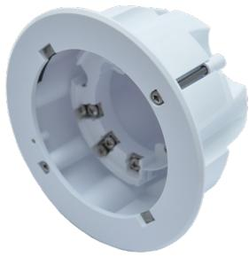
Монтажная коробка из поликарбоната для установки извещателей Soteria Dimension. Эта монтажная коробка устанавливается в пустоту потолка или предварительно устанавливается в сплошной потолок. Петля подключается к монтажной коробке, которая содержит разъемы для извещателей Soteria Dimension.
