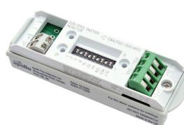
Модуль мониторинга переключения на DIN-рейку предназначен для отслеживания состояния одного или нескольких однополюсных бесконтактных kontaktов, подключенных к одной паре кабелей, для сообщения о состоянии. Он имеет настраиваемую задержку сообщения о состоянии, что делает его пригодным для мониторинга реле расхода.
