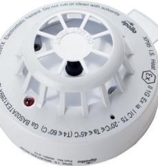
XP95 I.S. Термовой извещатель работает путем измерения уровня тепла с помощью одного термистора, который дает выходной сигнал, пропорциональный температуре наружного воздуха.
