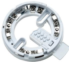
Все извещатели серий Soteria, Discovery и XP95 подходят для монтажной базы XPERT 8. Основание имеет широкий внутренний диаметр для облегчения доступа к кабелям и клеммам. Кроме того, извещатель можно зафиксировать в основании для повышения безопасности с помощью установочного винта с шестигранной отверткой 1,5 мм. Кarta XPERT 8, номер детали 38532-064, поставляемая с базой, имеет предварительно перфорированные штыри, которые необходимо удалить для установки адреса.
