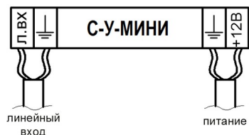
Рисунок 1. Схема внешних соединений оповещателя С-У-МИНИ
