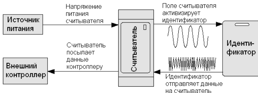
Рисунок 2. Функциональная схема, поясняющая работу считывателя
