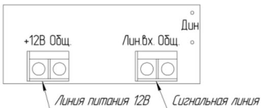
Рисунок 2. Схема внешних подключений оповещателя СОНАТА-У.
