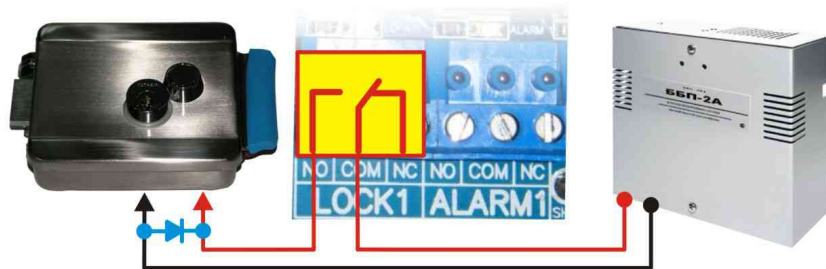
Рисунок 9: Управление электромеханическим замком
