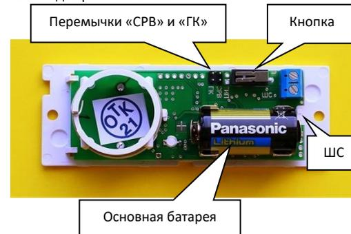
Поднесите извещатель к прибору. Двойным нажатием на кнопку извещателя инициируете передачу посылки на прибор. Прибор, получив эту посылку, обрабатывает её и выдает результат:
