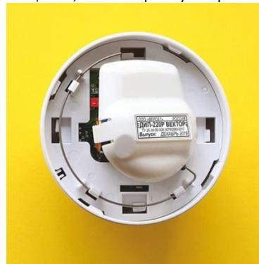
Для включения питания извещателя удалите (вытяните) бумажную ленту, изолирующую контакт основной батареи извещателя. Резервная батарея установлена и готова к работе.
