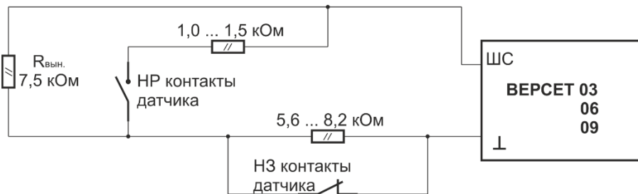
Рис.6. Схема включения технологических датчиков в ШСТ.
