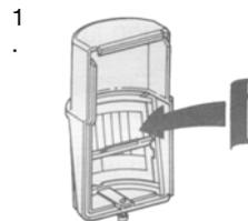
Снять корпус и приклеить полосы на внутреннюю поверхность линзы на те зоны, которые не нужны
