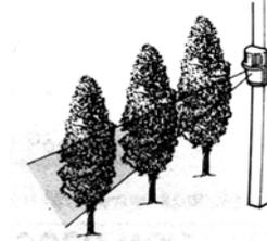
При установке избегайте движущихся объектов в зоне действия извещателя
