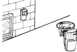
Используйте кронштейны CA-1W для настенного крепления и CA-2C – для потолочного крепления
