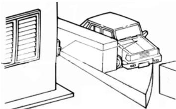
Направьте извещатель на стену или другую преграду для исключения ложных срабатываний
