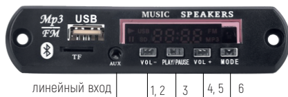
Рис. 25. Плеер, встроенный в блок речевого оповещения АРИЯ-ТСА-БРО
