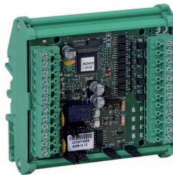
Корпус в сборе с установленным транспондером
