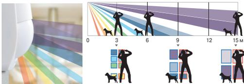
Область обнаружения FMX разделена на 78 плотно прилегающих друг к другу зон. В любой точке покрываемой области для проверки тревоги используется не менее 4 зон одновременно. Кроме того, логика счетверенных зон и микропроцессор CORE PLATFORM позволяют оценить инфракрасное излучение на цифровом уровне, что значительно повышает точность обнаружения нарушителей при отсутствии сработки на малых и средних животных.
