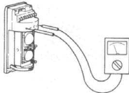
Подключить вольтметр к соответствующим контрольным клеммам (+) и (-)
