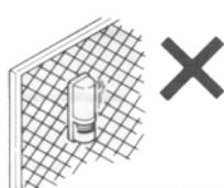
Монтировать только на твердую поверхность
