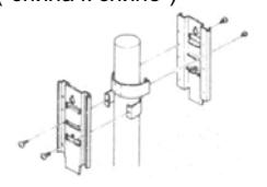
Зафиксировать два хомута один под одним на стойке, два извещателя могут быть установлены "спина к спине" на одной высоте
