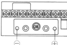
Контрольные клеммы расположены на передней части приемника
