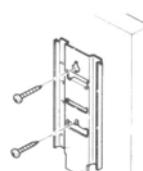
Пропустить кабель через кабельное отверстие на монтажной плате и присоединить плату к стене шурупами
