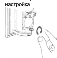
Глядя через видоискатель, поворачивайте колесо вертикальной настройки пальцами или отверткой
