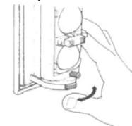
Глядя через видоискатель, поворачивайте колесо горизонтальной настройки
