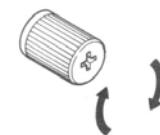
Поворот вертикальной настройки вправо передвигает линзу вверх, поворот вертикальной настройки влево сдвигает линзу вниз
