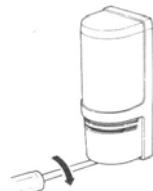
После проверки оптической регулировки и операций настройки (см. п. 5 "Оптическая настройка") установите крышку на место и зафиксируйте винтом.
