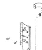
Разместить хомут сверху стойки. Пропустить кабель через кабельное отверстие на монтажной плате. Прикрепить монтажную плату и хомут винтами
