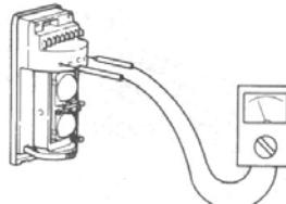
Установить диапазон измерения вольтметра 5-10 В пост. тока.
