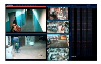
Видеоаналитический модуль SecurOS Helmet Detector разработан для повышения эффективности производственного контроля в рамках направления «Охрана труда и промышленная безопасность» (ОТиПБ) и обеспечивает автоматическую детекцию случаев несоблюдения людьми правил техники безопасности в отношении использования средств индивидуальной защиты — защитных касок.
