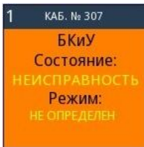
Рисунок 40 – Вид ярлыка объекта при неисправности линии связи
