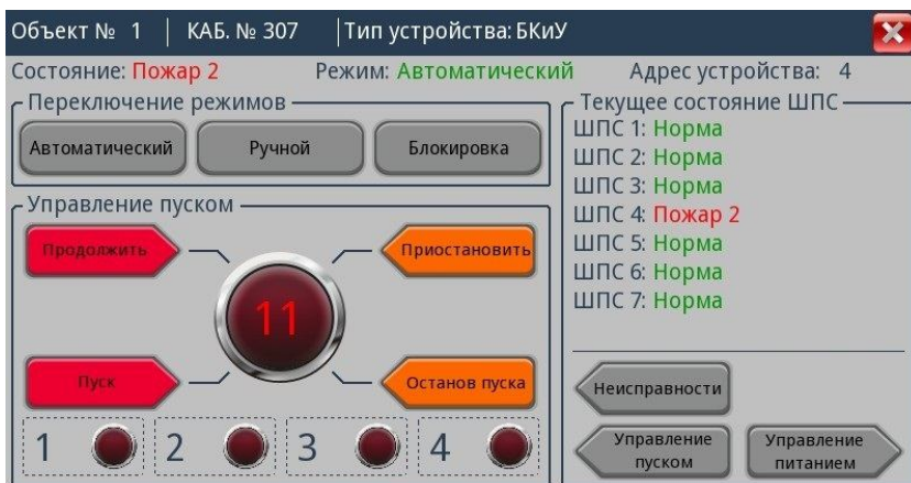
Рисунок 53 – Вид окна направления с отсчётом таймера
