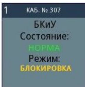
Рисунок 47 – Вид ярлыка объекта переведенного в режим блокировки
