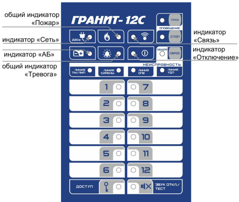
Рис.2 Панель индикации и управления прибора Гранит-12С
