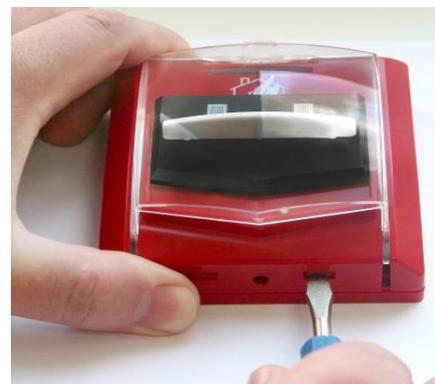
Для включения питания извещателя удалите (вытащите) ленту, изолирующую контакт основной батареи извещателя. Резервная батарея установлена и готова к работе.
