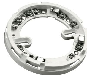
Стандартное основание Series 65 позволяет устанавливать извещатели без применения силы, что особенно полезно при установке на подвесные потолки. Все базы Series 65 подходят только в одном направлении. Детекторы можно зафиксировать установочным винтом с помощью шестигранной отвертки 1,5 мм.
