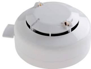
Оптический / тепловой мультисенсорный извещатель Soteria использует технологию оптического зондирования PureLight для обнаружения частиц дыма, попадающих в камеру, и оснащен двумя термисторами для определения тепла. Его можно переключить на обнаружение дыма, тепла или их комбинации, что обеспечивает большую гибкость.
