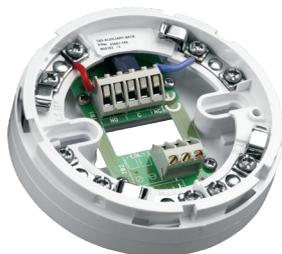
База вспомогательных реле серии 65 имеет два набора беспотенциальных переключающих контактов для облегчения переключения удаленного светодиода или другого вспомогательного устройства.
