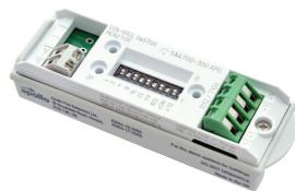
Модуль мониторинга переключения на DIN-рейку предназначен для отслеживания состояния одного или нескольких однополюсных беспотенциальных контактов, подключенных к одной паре кабелей, для сообщения о состоянии. Он имеет настраиваемую задержку сообщения о состоянии, что делает его пригодным для мониторинга реле расхода.
