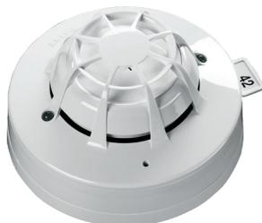
Мультисенсорный извещатель Discovery включает в себя оптические датчики дыма и термисторные датчики температуры, которые подают как комбинированный, так и отдельный тепловой сигнал для улучшения управления ложными тревогами.
