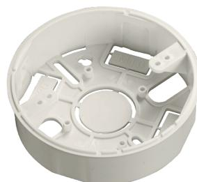
Коробка для кабелепровода - это универсальный аксессуар для поверхностного монтажа баз Apollo. Коробка имеет отверстия для кабельных вводов PG16 или M20, кабелепровода или мини-короба. В комплект входят саморезы для крепления основания извещателя к распределительной коробке.
