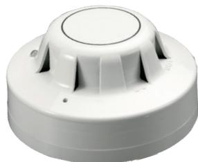
Оптический дымовой извещатель серии 65 включает в себя пульсирующий светодиод, расположенный внутри корпуса извещателя. Внешний вид извещателя имеет светодиодный индикатор, который горит в состоянии покоя, но при тревоге горит красным светом.
