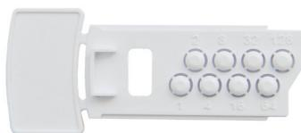
Карты XPERT 8 поставляются со всеми монтажными базами XPERT 8. С помощью направляющей для кодирования удаляются шипы для установки адреса вставленного извещателя.
