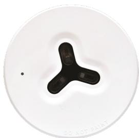
Новаторский дизайн оптического извещателя Soteria Dimension отличается от стандартных пожарных извещателей отсутствием камеры и установкой заподлицо. Новая технология оптического зондирования используется для обнаружения частиц дыма вне корпуса извещателя. Комбинация инфракрасных (ИК) светодиодов и фотодиодов идентифицирует частицы дыма, обнаруживаемые непосредственно под корпусом извещателя, и инициирует тревогу.
