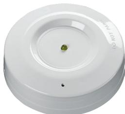
Изолятор размещается на петле через определенные промежутки и гарантирует, что в случае короткого замыкания будет затронута только часть между изоляторами. Когда короткое замыкание устранено, изоляторы автоматически восстанавливают питание и данные в изолированной секции.
