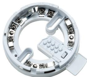
Все извещатели серий Soteria, Discovery и XP95 подходят для монтажной базы XPERT 8. Основание имеет широкий внутренний диаметр для облегчения доступа к кабелям и клеммам. Кроме того, извещатель можно зафиксировать в основании для повышения безопасности с помощью установочного винта с шестигранной отверткой 1,5 мм. Карта XPERT 8, номер детали 38532-064, поставляемая с базой, имеет предварительно перфорированные штыри, которые необходимо удалить для установки адреса.
