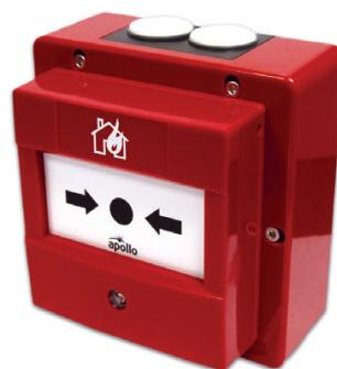
Водонепроницаемый ручной извещатель Apollo имеет хорошо видимый индикатор тревоги, который можно увидеть на расстоянии до 10 метров. При активации ручной извещатель прерывает цикл опроса для быстрого ответа. Комбинированный светодиодный индикатор и передний механизм сброса позволяют выполнить простой сброс.
