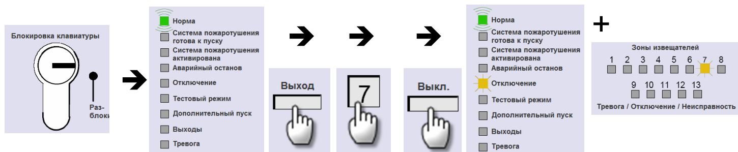
Рис. 9: Пример управления – выключение релейного выхода №7
