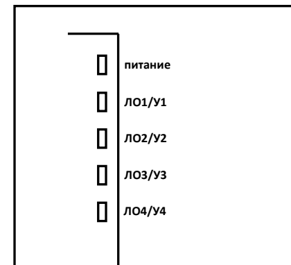
Рисунок-1 Схема расположения световых индикаторов на верхней крышке БКЛО
